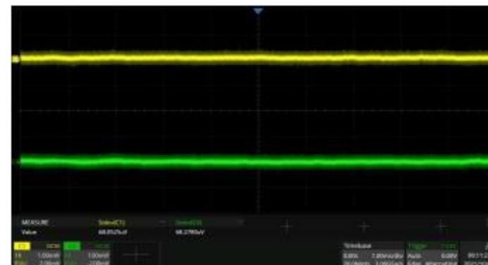
低ノイズフロア: 200 MHz帯域幅でわずか70  $\mu$ Vrms
