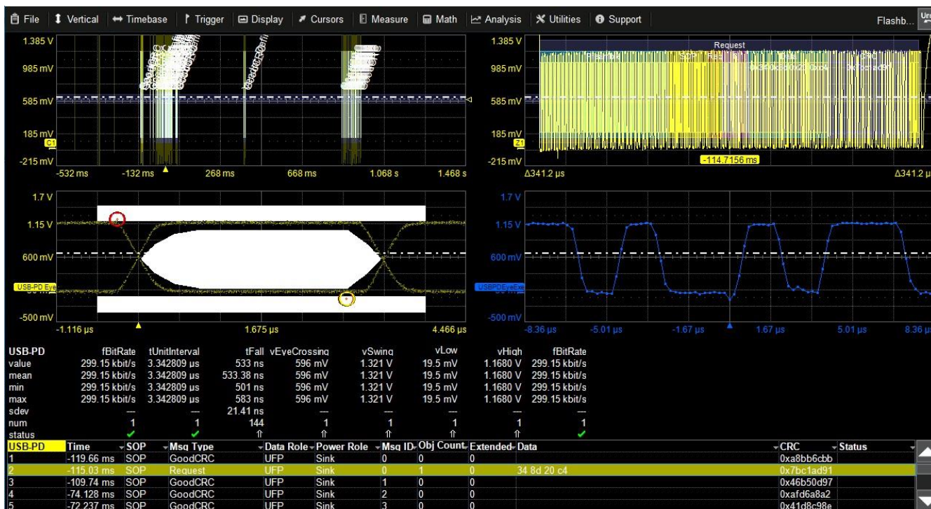
デコードされた USB-PD データの PHY 測定とアイマスクテスト
