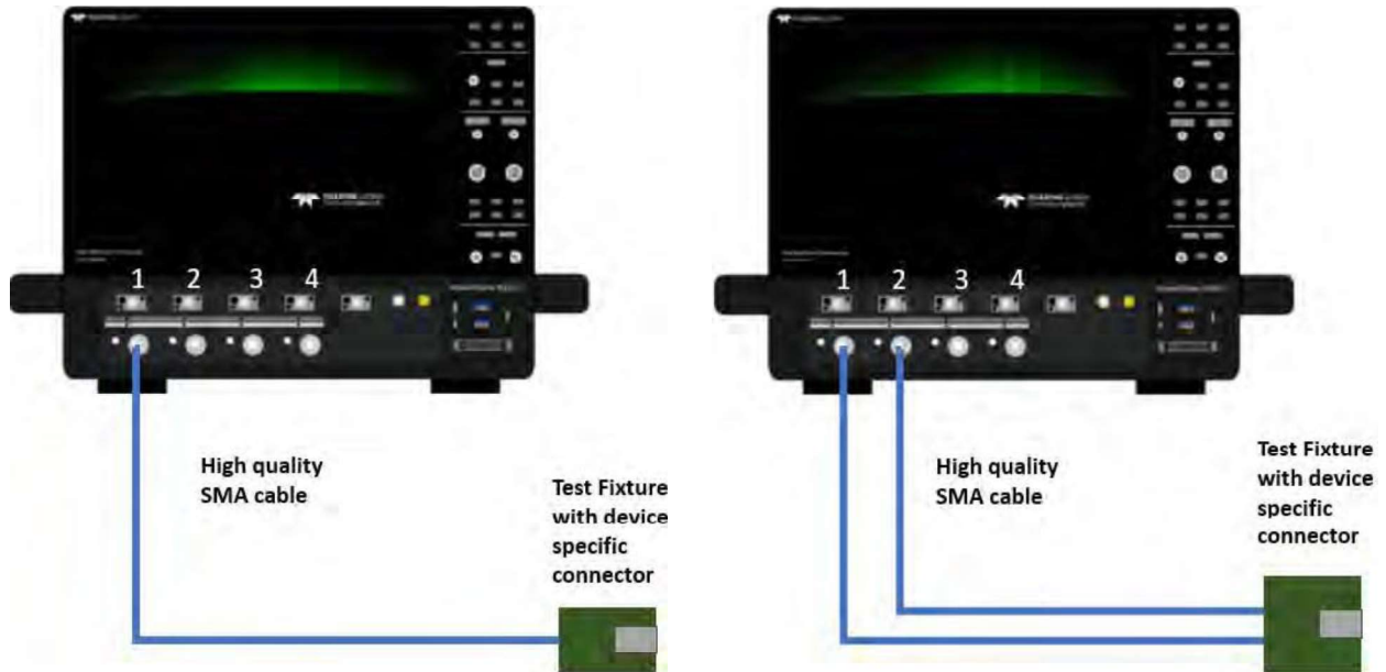
図 29: 同軸コネクタ(左)とツイストペアコネクタ(右)の接続図
