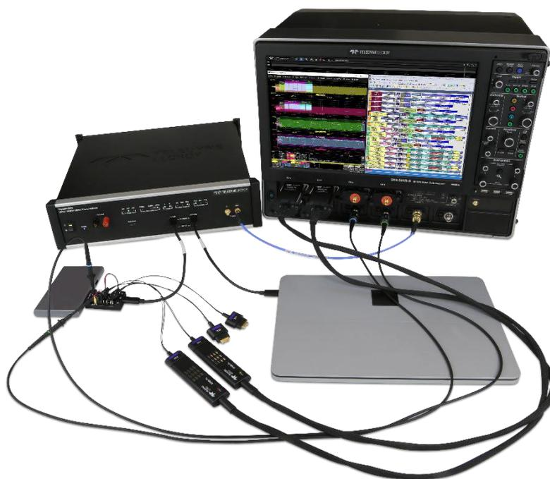
図2: 典型的なアナライザモードのセットアップ
